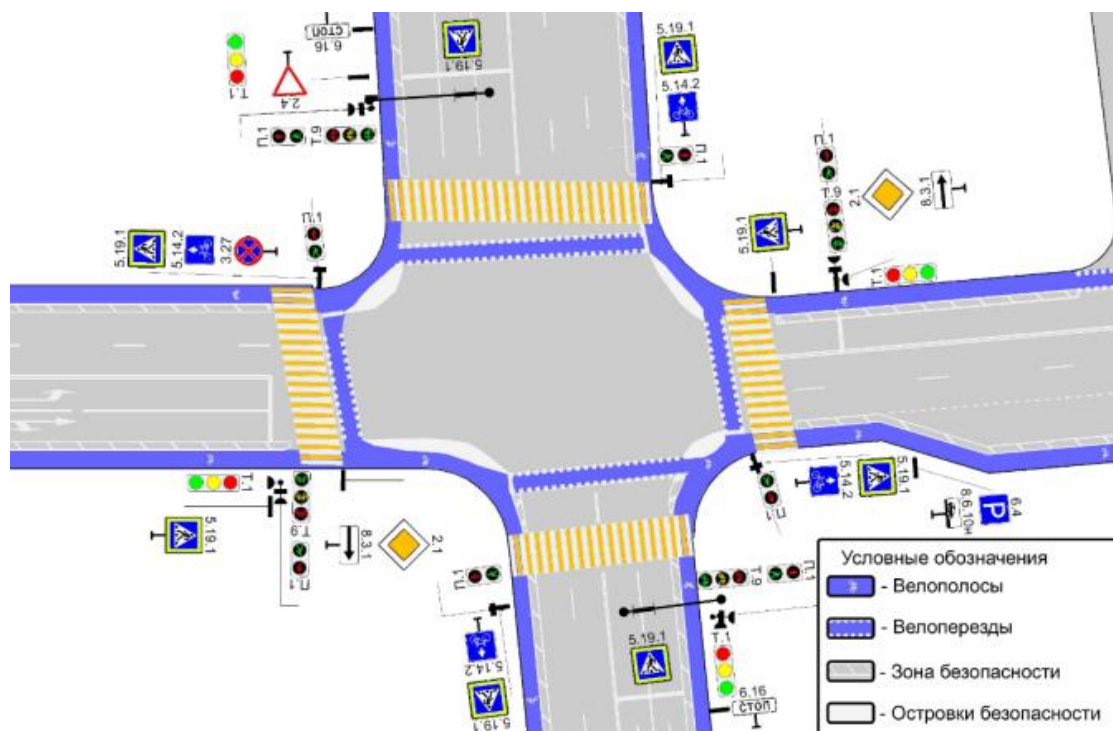
Рис. 3. Предлагаемая схема дислокации технических средств ОДД на пересечении улиц Советской и Комсомольской
