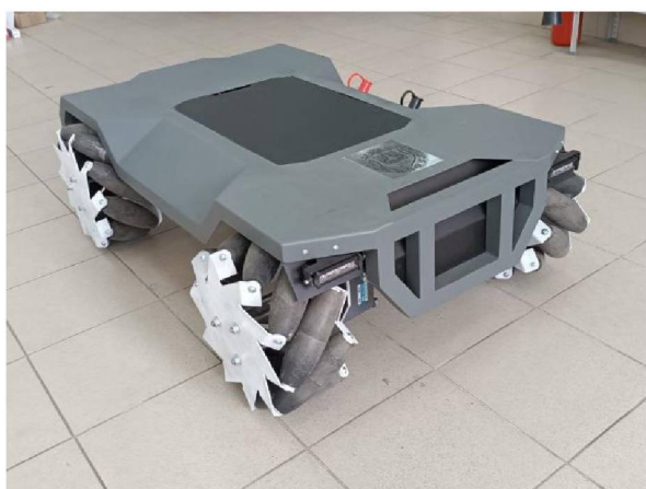
Рис. 1. Транспортное средство с всенаправленными колесами
