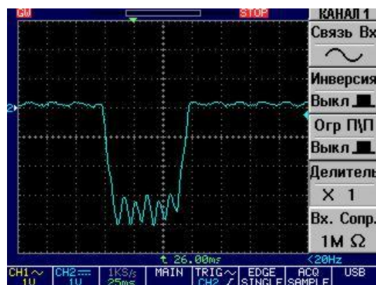
Рис. 2. Характерная осциллограмма электрического сигнала фотоэлемента от лампочки накаливания N = 40 \text{ Вт}
