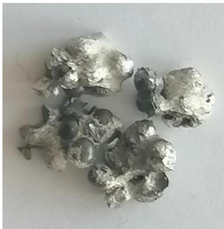
Рис. 2. Частицы свинца в расплаве сплава «Вуда»
