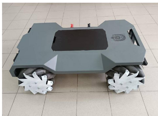
Рис. 1. Транспортное средство с всенаправленными колесами
