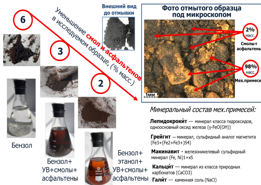
Рис. 1. Техногенные отложения из нагнетательной скважины (с турбожелонки), отмытые бензолом и спиртобензольной смесью
