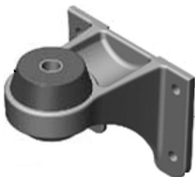
Рис. 2. Конструкция упругой опоры крепления кузова к раме
