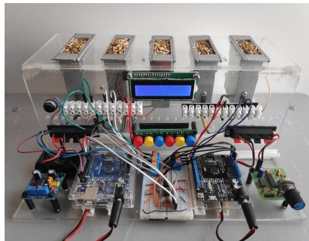
Рис. 4. Опытный образец ИИС для оценки влажности и примесей сельскохозяйственных продуктов
