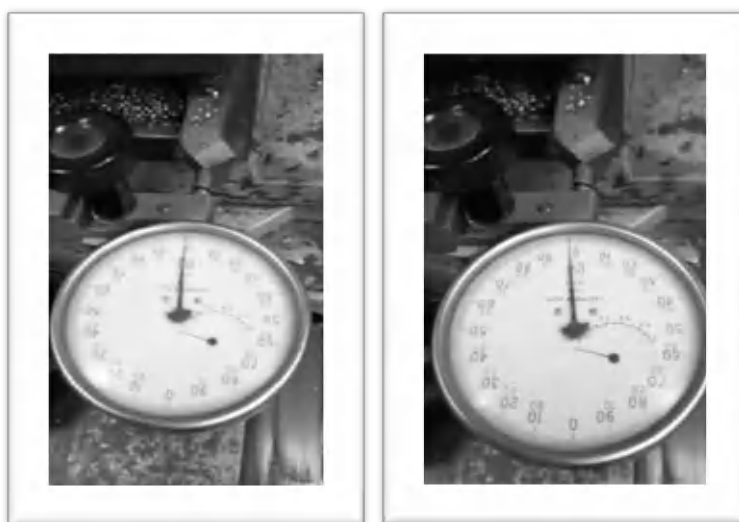
Рис. 3. Кадры съемки на мобильное видео процесса остывания резца после 3 и 6 минут обработки
