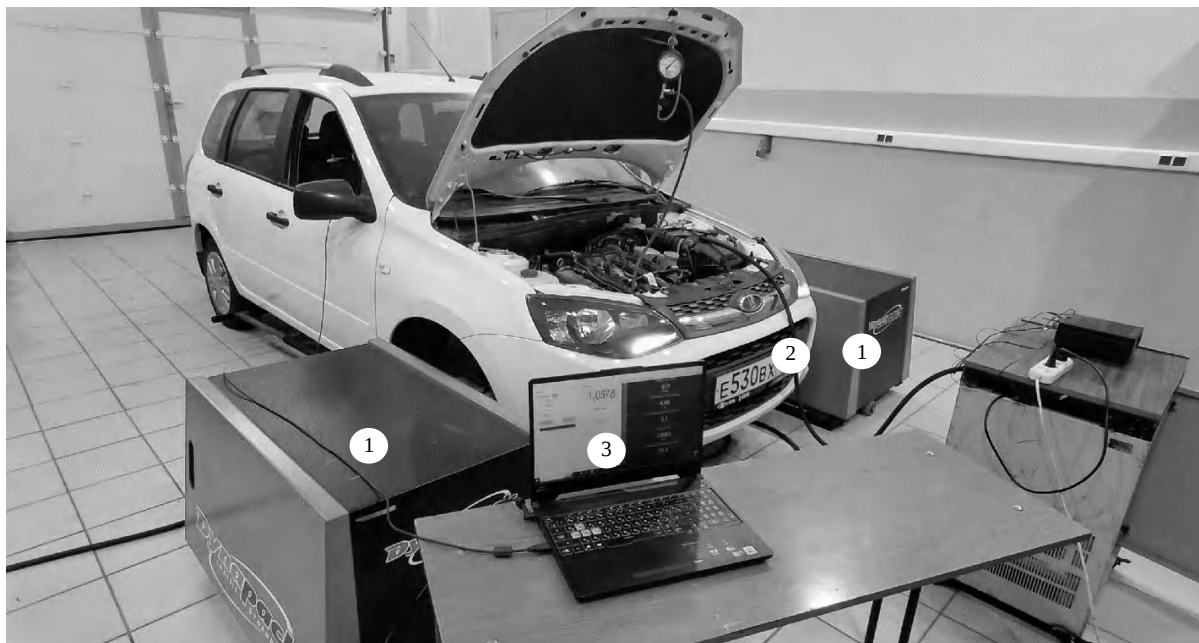
Рис. 1. Автомобиль ВАЗ-21126 на испытательном стенде Dynapack DAQ+ V43: 1 – динамометрический ступичный стенд, 2 – топливопровод, подключенный к топливной рампе автомобиля, 3 – персональный компьютер
