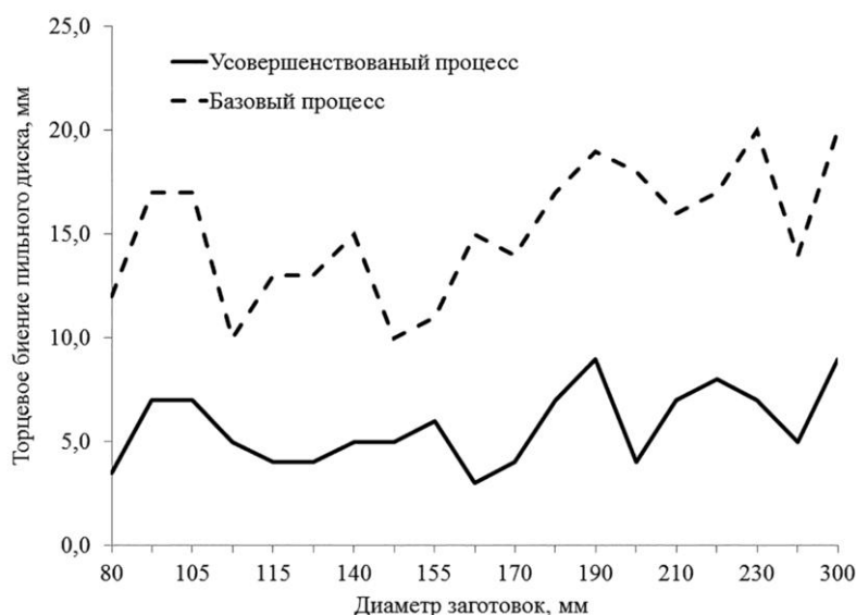
Рис. 4. График зависимости торцевого биения пыльного диска от диаметра заготовки для базового и усовершенствованного процесса резания
