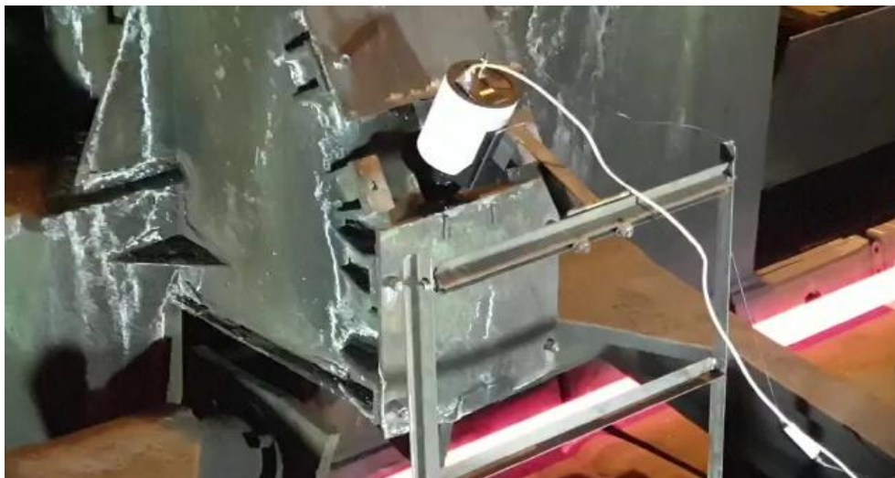
Рис. 1. Наблюдение скоростной видеокамерой за биением пильного диска в процессе резания через вырезанное окно в кожухе
