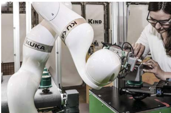
Рис. 4. Совместное выполнение сборочно-монтажных операций с помощью МИСП
