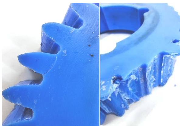
Рис. 1. Примеры сломанных зубьев и разрушения пластиковой шестерни
