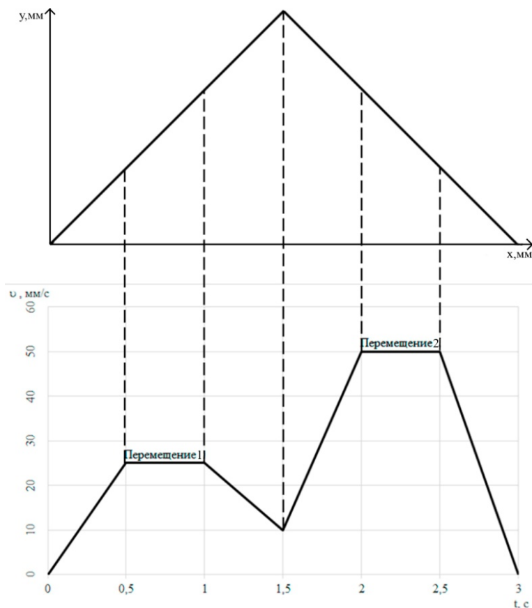
Рис. 1. Изменение скорости при повороте на угол 90 градусов с использованием «look-ahead»
