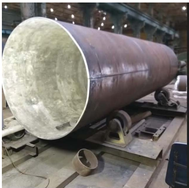
Рис. 1. Емкость для хранения щелочи NaOH из никель-стального биметалла
