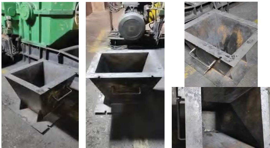
Рис. 1. Воронки накопительных бункеров смесителей анодной массы, используемые на анодной фабрике ОК «РУСАЛ»
