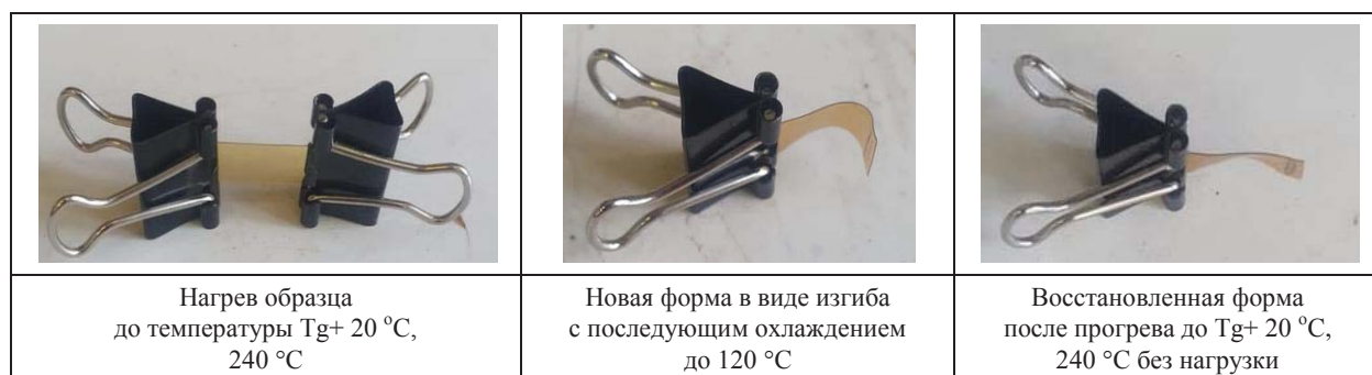
Рис. 2. Наглядный опыт U-shape bending test для ПЭИ
