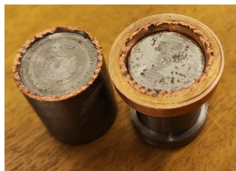
Рис. 4. Схема испытаний прочности соединения слоёв на отрыв плакирующего слоя (а) и образец сталь-медь после испытаний на отрыв плакирующего слоя (б):
