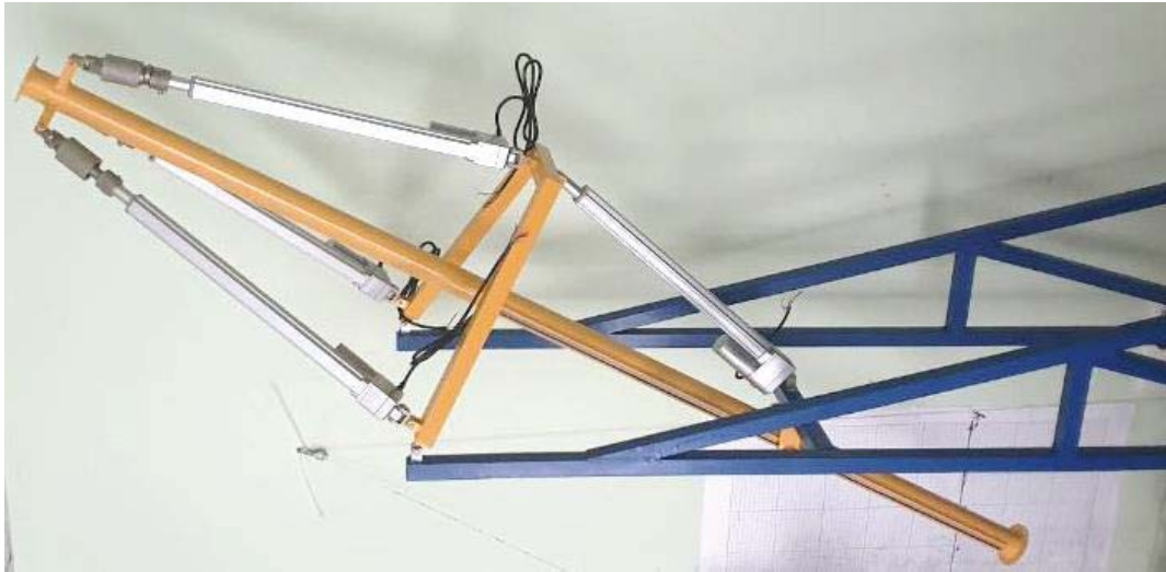
Рис. 2. Манипулятор-трипод с дополнительной пассивной связью
