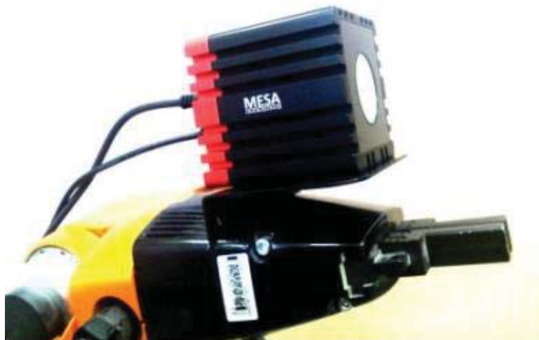
Рис. 2. Вариант крепления камеры к захвату манипулятора
