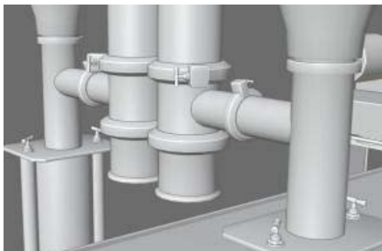
Рис. 4. Устройство для заливки продукта в стаканы
