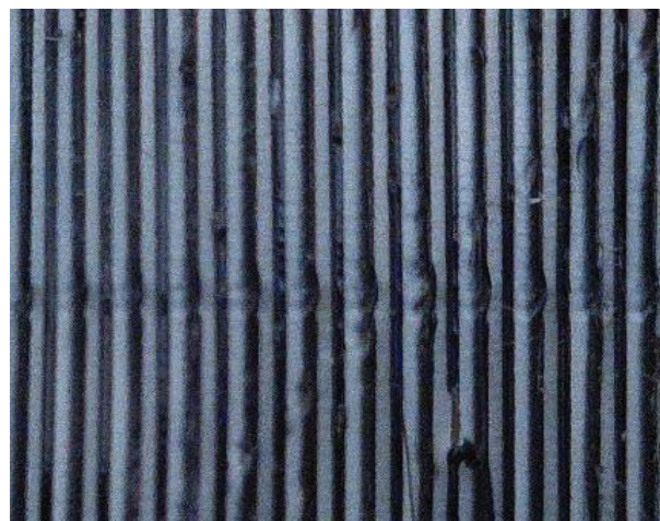
Рис. 4. Структура слоя напечатанного изделия
