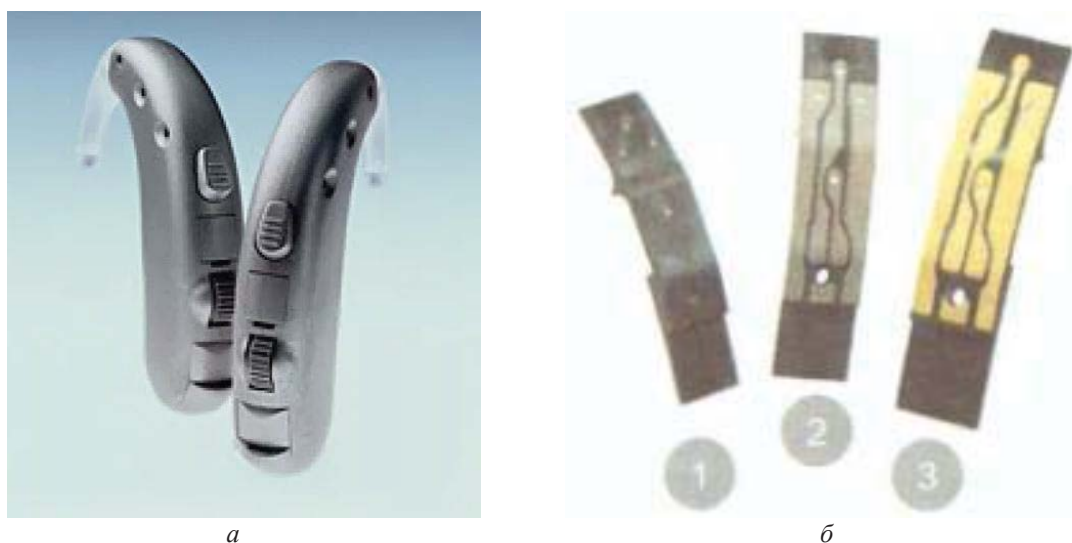
Рис. 3. Составные части заушного слухового аппарата: а – заушная (аппаратная) часть; б – монтажное основание (1 – формообразование литьем под давлением, 2 – лазерное структурирование, 3 – металлизация)
