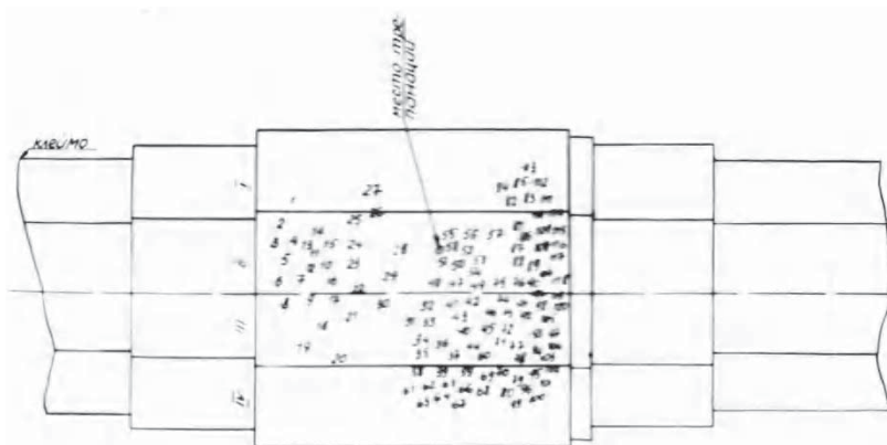
Рис. 1. Схема расположения дефектов, выявленных при УЗК в поковке роторного вала марки 35ХН1М (масса слитка 71,5 т)
