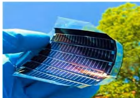
Рис. 17. CdTe солнечный элемент на подложке прозрачной ПИ пленки
