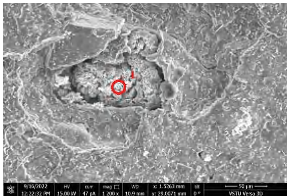
Рис. 2. СЭМ изображение поверхности глины, модифицированной формиатом никеля при разном увеличении
