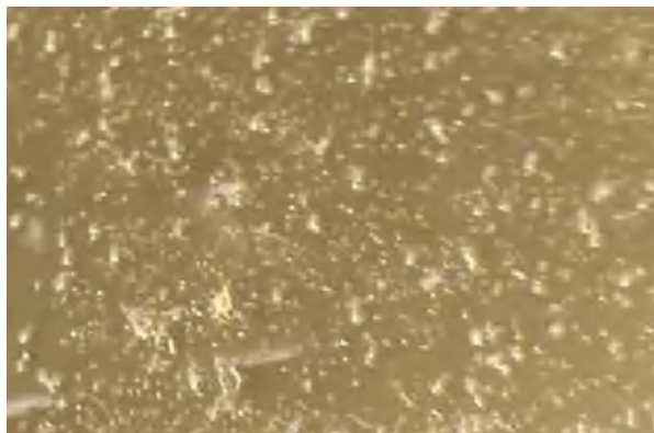
Рис. 9. Поверхности образцов смоляной композиции в поле зрения оптического микроскопа МБС-9 при 32-кратном увеличении
