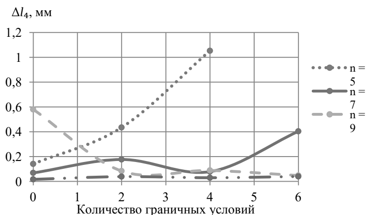
Рис. 5. График зависимости значений максимальных отклонений обобщенной координаты \Delta l_4 от степени полинома и числа граничных условий
