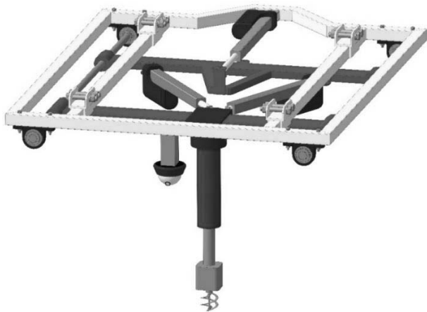
Рис. 4. 3d-модель модуля дискретной прецизионной прополки сорняков в рядках
