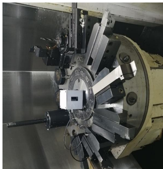
Рис. 3. Прототип устройства для автоматизированного назначения режимов обработки на токарном станке с ЧПУ GENOS OKUMA – L300M в сборе в пластиковом корпусе в рабочем положении
