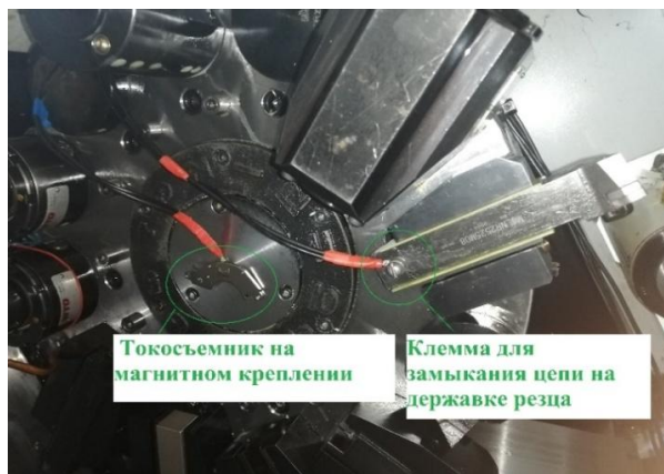
Рис. 1. Закрепление токосъемника с магнитным креплением на револьверной головке токарного станка с ЧПУ GENOS OKUMA – L300M
