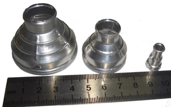
Рис. 4. Штампосварные экранирующие облегченные корпуса электросоединителей, диаметры D=10-40 мм, длины L=15-30 мм
