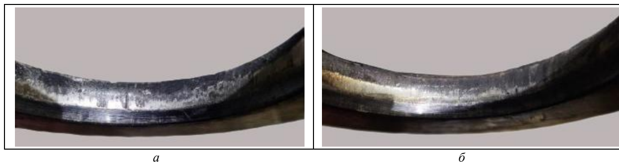
Рис. 2. Отбраковка опытных матриц производства ТПЦ-2: риски и наплывы (уменьшение диаметра): а – отработанная матрица – 6 прессований; б – отработанная матрица – 9 прессований
