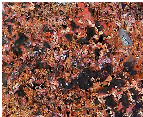
Рис. 3. Структура пеномеди образца диаметром 10 мм с размером пор 20–50 мкм
