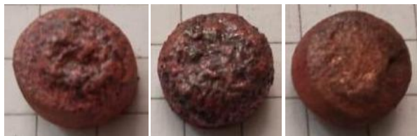
Рис. 2. Пеномедные образцы диаметром 10 мм с порофором CaCO 3
