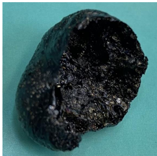
Рис. 4. Структура коксового остатка эпоксидного композита содержащего 1,5 масс. ч. модификатора № 1
