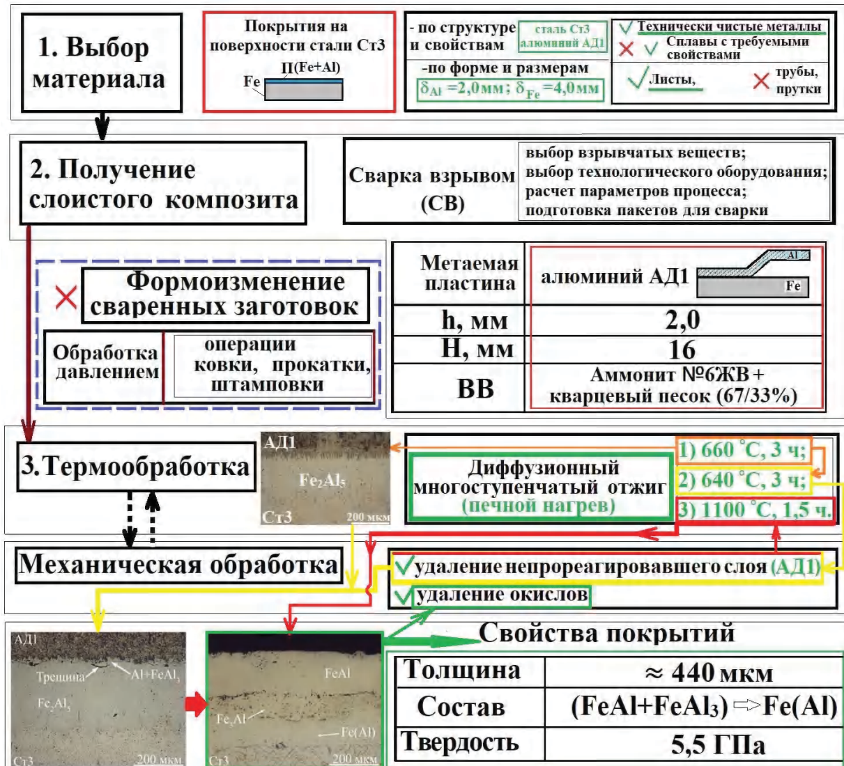
Рис. 1. Технологическая схема получения покрытий системы Fe-Al [8]
