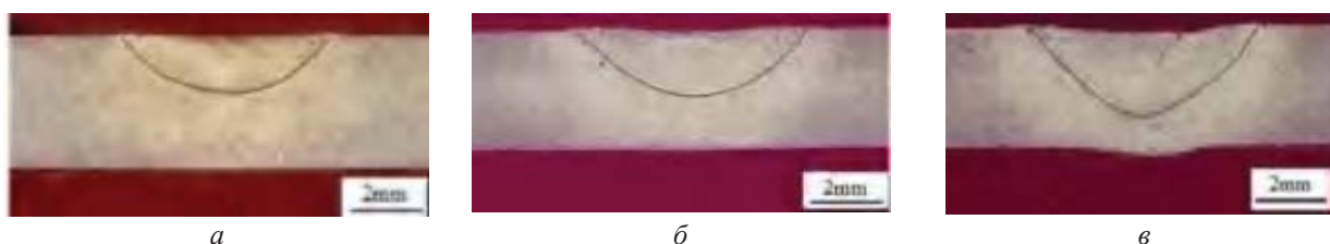
Рис. 1. Влияние мощности УЗК на глубину проплавления: а – без УЗК; б – 400 Вт; в – 1000 Вт [6]
