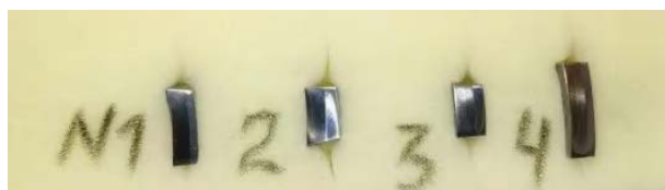
Рис. 3. Образцы для изучения микротвердости (темный слой – ВТ1, светлый – АМг2)
