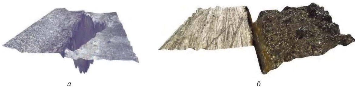
Рис. 3. 3D-реконструкция профиля коррозионных поражений на начальном (а) и конечном (б) этапе испытаний
