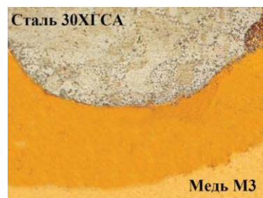
Рис. 5. Микроструктура диффузионной зоны при нагреве 1000 °С, 24 ч x500
