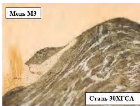
Рис. 3. Микроструктура зоны соединения композита медь МЗ+сталь 30ХГСА после сварки взрывом (а) \times 50 и распределение микротвердости по сечению биметалла (б)
