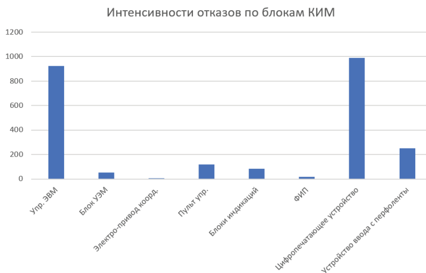
Рис. 3. График интенсивностей отказов по блокам КИМ
