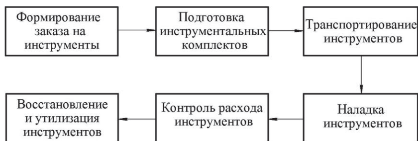
Рис. 2. Схема формирования и эксплуатации инструментальных комплектов в АСИО
