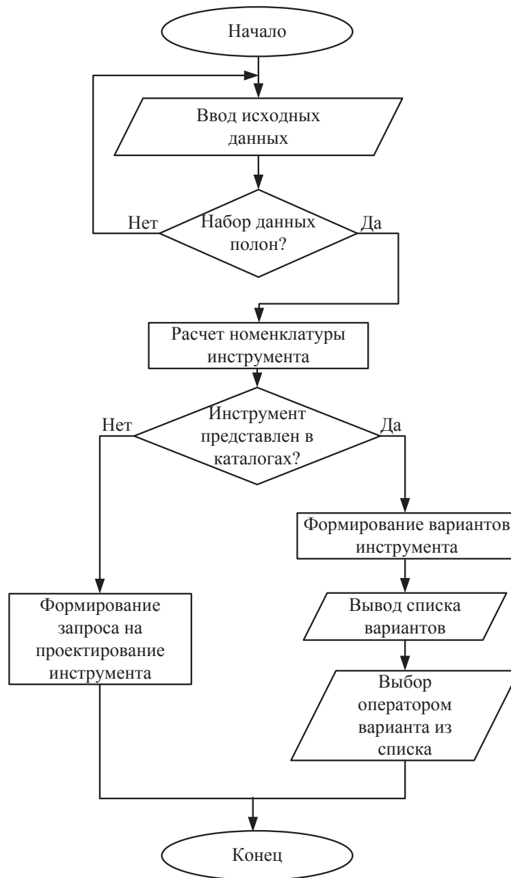
Рис. 1. Алгоритм выбора оптимального инструментального комплекта
