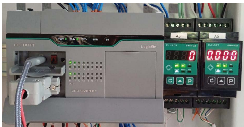
Рис. 4. Разработанный стенд на базе ПЛК LogicOnCPU 12/8NDC
