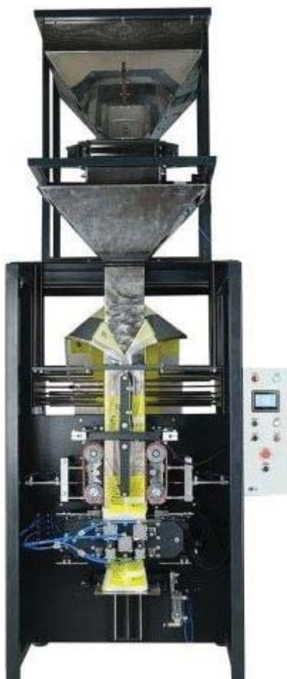
Рис. 1. Фасовочно-упаковочный автомат с весовым дозатором «СБМ»
