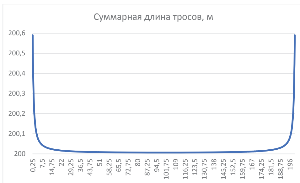
Рис. 3. Суммарная длина тросов при перемещении робота вдоль рабочего пространства
