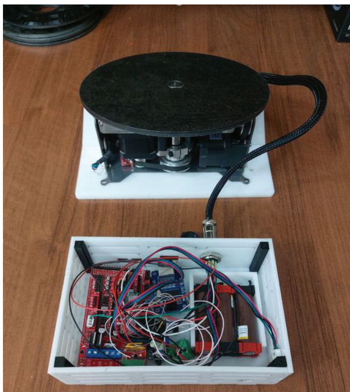
Рис. 3. Двухосевой поворотный стол и блок управления
