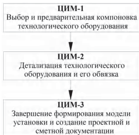
Рис. 2. Этапы проектирования с использованием ЦИМ
