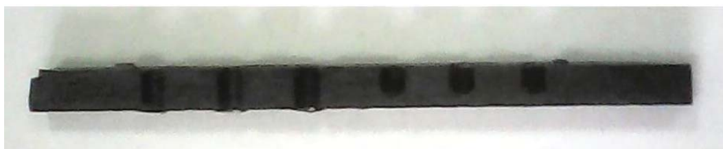
Рис. 1. Образец со сквозными и глухими отверстиями. Разъем по средней плоскости отверстий
