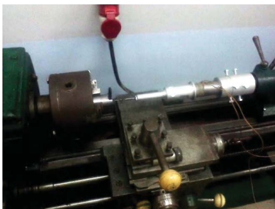
Рис. 1. Рабочая зона станка ТВ-106 с ультразвуковым преобразователем
