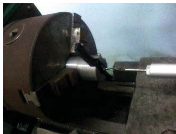
Рис. 1. Рабочая зона станка ТВ-106 с ультразвуковым преобразователем
