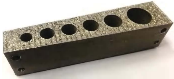
Рис. 1. Изготовленный образец с отверстиями различного диаметра
