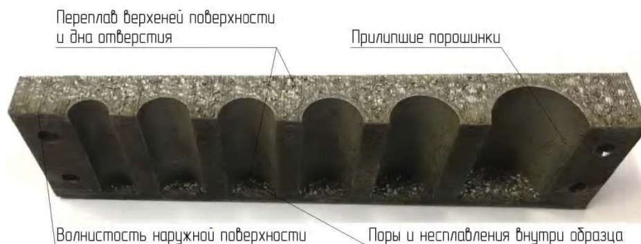
Рис. 2. Дефекты изготовленного образца
