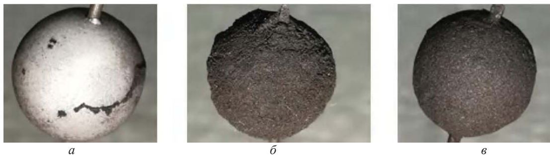
Рис. 4. Фотоснимки гранул вспененного полистирола после нанесения токопроводящего слоя различными способами:
