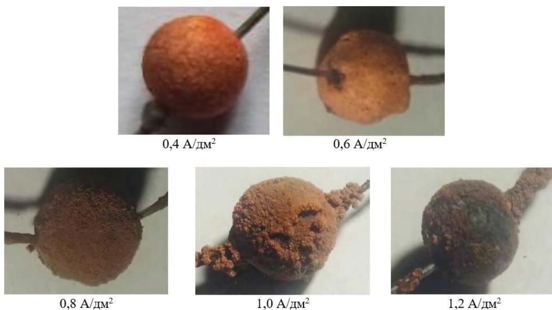
Рис. 5. Образцы порообразователя после металлизации при различной плотности тока и времени выдержки 60 минут
