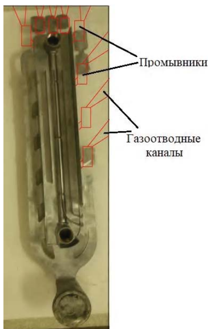
Рис. 6. Рекомендуемая схема расположения промывников и газоотводных каналов
