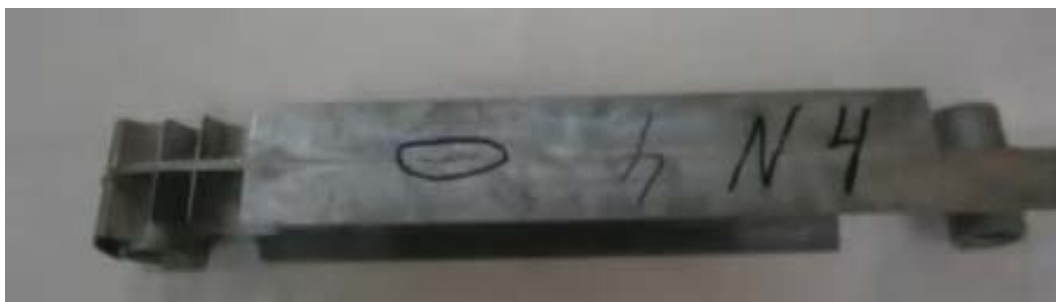
Рис. 1. Радиатор с дефектами по линии разъема пресс-формы
