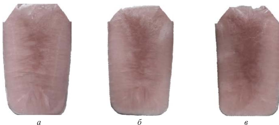
Рис. 2. Макроструктура модельных слитков:
