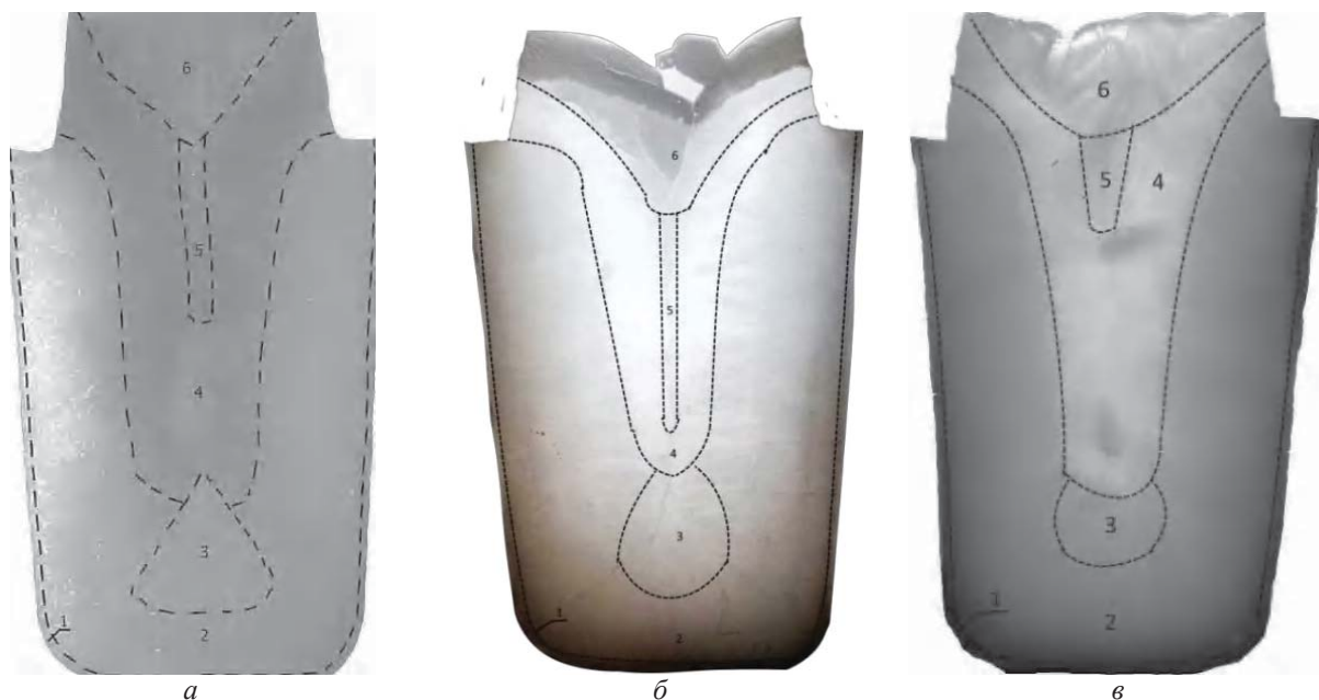
Рис. 5. Структурные зоны модельных слитков:
