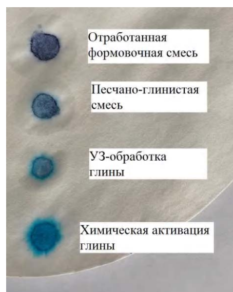
Рис. 2. Капли формовочных смесей с метиленовым голубым
