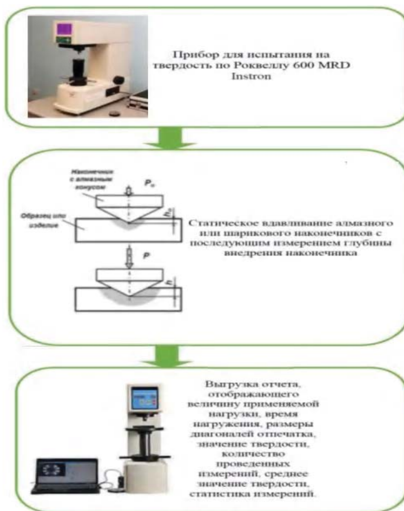
Рис. 1. Блок-схема методики исследования твердости по Роквеллу
