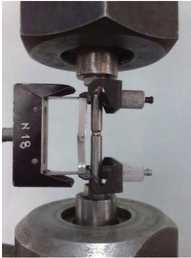
Рис. 3. Образец с выточкой в захватах испытательной машины УМЭ-10Т
