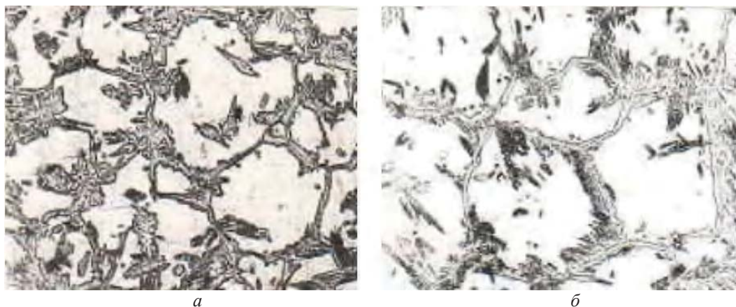
Рис. 2. Микроструктура металла участка перегрева ЗТВ сварных соединений сталей 08X22H6T (а), 08X18Г8Н2Т (б), \times 100
